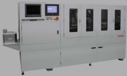
BGA・CSPシステムは、携帯電話、PDA、自動車部品などに使用される半導体の表面実装を行う最先端の装置である。マイクロボールマウンタ「BM-1100W」は、業界初のボール振込方式により、70μmボールの12インチウェハーへの一括搭載を実現している。
